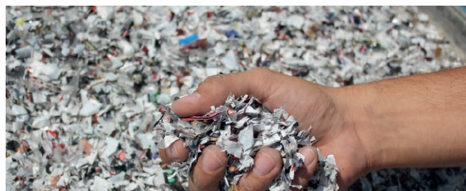
CSR fabricat a l'empresa PRONATUR. Combustible alternatiu procedent de la valorització.
