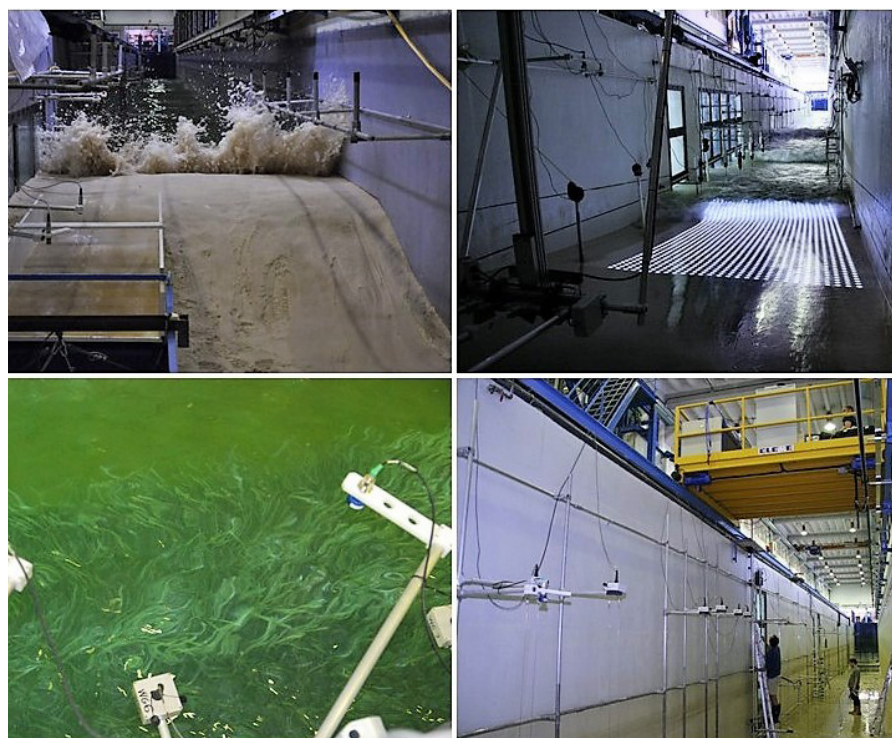
Resum gràfic dels assajos amb fons mòbil (a dalt a l'esquerra) i de la instrumentació òptica (a dalt a la dreta), dels equipaments acústics fora de l'aigua (a baix a l'esquerra) i de la instrumentació general del canal (a baix a la dreta).
